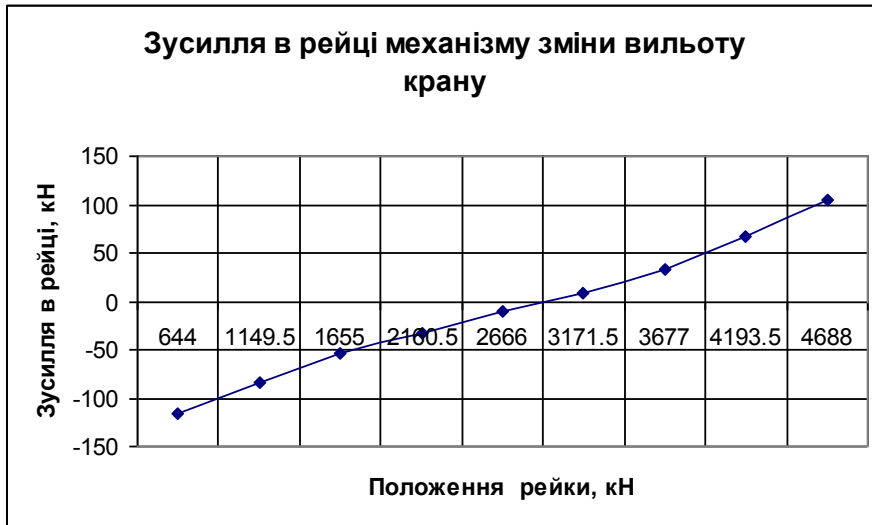
Рисунок 3.21 – Діаграма зусиль в рейці механізму зміни вильоту для різних положень рейки
